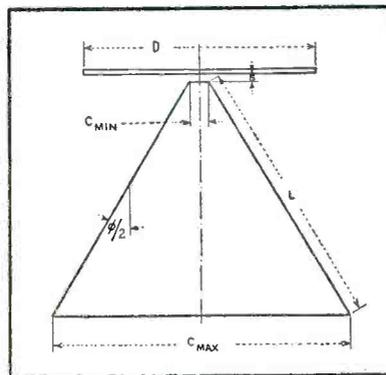
FIG. 1—Discone antenna parameters
